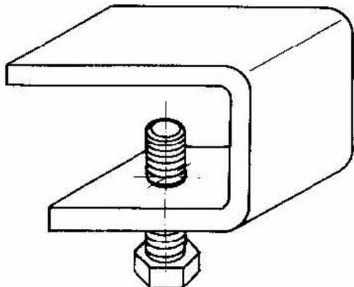
**Pezzo di bloccaggio - Materiale di montaggio per il vano cavi GRK 25**
