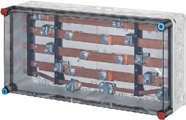
Dotato di set di barre si, Corrente nominale sistema a rotaia 400 A, Materiale dell'alloggiamento Plastica, Altezza 300 mm, Larghezza 600 mm, Profondità 170 mm, Possibilità di montaggio si, Tipo di montaggio Sopra-intonaco, Con coperchio trasparente si, Resistenza al cortocircuito (Icw) 15 kA, Numero di poli 5, Grado di protezione (IP) IP65
