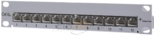
Numero di bussole/giunti 12, Idoneo per numero di prese/giunti 12, Tipo di connettore a innesto RJ45 8(8), Schermato sì, Categoria 6A (IEC), Tipo di collegamento LSA, Numero di unità di altezza (HE) 1, Colore grigio, Numero RAL 7035, Tipo di montaggio Montaggio 254 mm (10 pollici), Altezza 44 mm, Larghezza 255 mm, Profondità 96 mm
