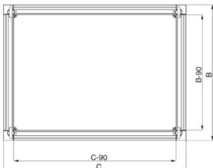
Larghezza 600 mm, Altezza 300 mm, Profondità 800 mm, Idoneo per larghezza alloggiamento 600 mm, Idoneo per profondità alloggiamento 800 mm, Materiale Acciaio, Versione della superficie rivestimento a polveri, Colore grigio, Numero RAL 7035, Con ingresso cavi no
