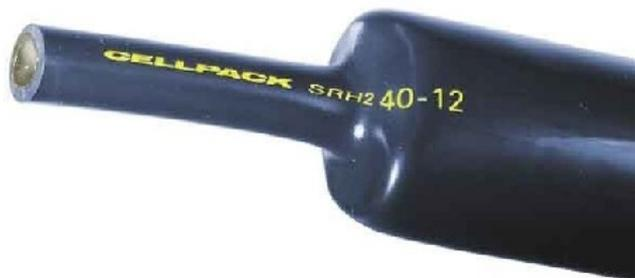
Tipo Termoretraibile, Versione a parete centrale, Tasso di contrazione 3:1, Diametro interno prima della contrazione 22 mm, Diametro interno dopo contrazione 6 mm, Diametro nominale in pollici altro, Spessore parete dopo contrazione 2,6 mm, Lunghezza 1 m, Temperatura di esercizio -40..120 °C, Colore nero, Trasparente no, Materiale Poliolefine (PO-X), Privo di alogeni sì, Con adesivo interno sì, Stampabile sì, Autorizzazione UL no
