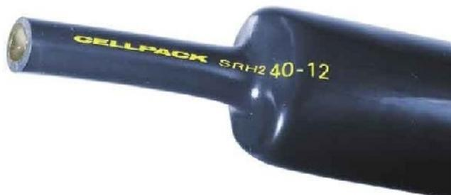
Tipo Termoretraibile, Versione a parete centrale, Tasso di contrazione 3:1, Diametro interno prima della contrazione 34 mm, Diametro interno dopo contrazione 7 mm, Diametro nominale in pollici altro, Spessore parete dopo contrazione 2,6 mm, Lunghezza 1 m, Temperatura di esercizio -40..120 °C, Colore nero, Trasparente no, Materiale Poliolefine (PO-X), Privo di alogeni si, Con adesivo interno si, Stampabile si, Autorizzazione UL no
