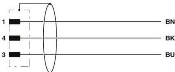
Numero di poli 3, Disposizione della guida cavi, lato campo altro, Lunghezza cavo 10 m, Materiale del rivestimento cavo Polivinilcloruro (PVC), Privo di alogeni no, Colore del rivestimento cavo giallo, Con display LED no, Schermato si, Tipo di cavo a più fili, Reticolato no, Materiale del corpo base di contatto CuSn, Materiale del rivestimento di contatto Nichel/oro, Corrente nominale In 4 A, Tensione nominale 48 V, Resistenza di contatto 5000 mOhm, Grado di protezione (IP) IP65
