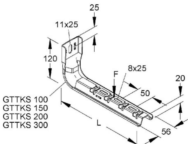
Lunghezza 215 mm, Larghezza 56 mm, Altezza 120 mm, Idoneo per larghezza sistema di supporto cavi 100..150 mm, Versione Staffa di supporto e per fissaggio a parete, Angolo 90 °, Portata 1,08 kN, Idoneo per mantenimento della funzione no, Materiale Acciaio, Qualità materiale altro, Protezione superficie zincato
