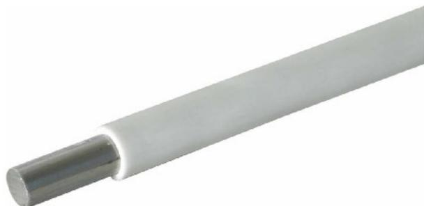
Diametro conduttore 8 mm, Sezione conduttore 50 mm<sup>2</sup>, Diametro esterno incluso involucro/rivestimento 11 mm, Classe conduttore Kl.1 = monofilare, Numero di fili singoli 1, Materiale conduttore Alluminio, Proprietà materiale conduttore morbido, Protezione superficie non trattato, Materiale di rivestimento plastica priva di alogeni, Colore bianco, Versione isolata a prova di alta tensione no, Idoneo per aree esplosive no, Peso 20 kg/100 m
