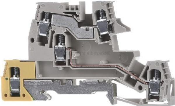
Corrente nominale In 26 A, Tensione nominale 400 V, Numero di potenziali 3, Tipo di montaggio Guida DIN TH35, Materiale del corpo isolante Termoplastico, Temperatura di esercizio -40..55 °C, Larghezza 6 mm, Profondità 90 mm, Necessaria piastra di chiusura sì, Colore di base grigio, Con funzione PE sì, Con cursori di sezionamento del neutro senza vite no, Funzione N possibile sì
